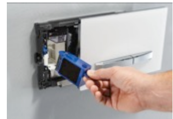
Geberit_DuoFresh_Modul_Aktivkohlefilter.jpg Ein Lüfter saugt die belastete Luft direkt aus der WC-Keramik an und reinigt diese über einen Keramikwabefilter. Die frische Luft wird dann wieder in den Raum zurückgeführt.
